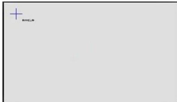
Verwenden Sie den im Lieferumfang enthaltenen Stift und berühren Sie (einige Sekunden halten) die Mitte jedes Kreuzes . Nach dem Markieren von vier Punkten wird die
